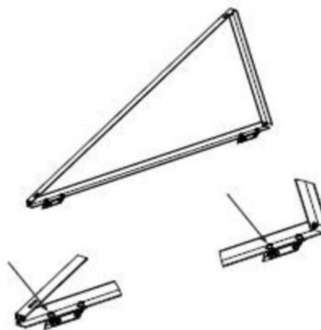
Falsfäste för dubbelfalsat plåttak
