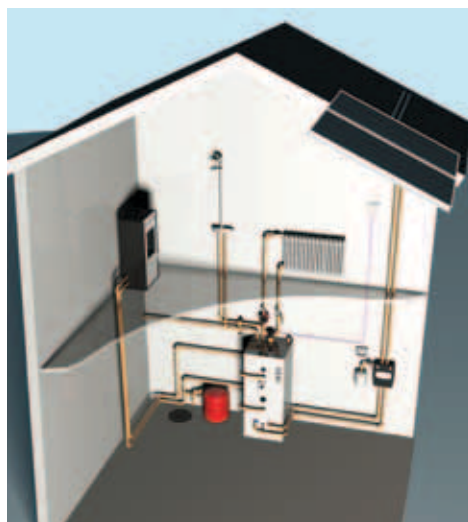
Principskiss vattenmantlad pelletskamin – solvärme
